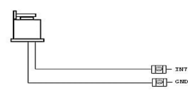
Рис. 18. Схема подключения датчика высоты инструмента
