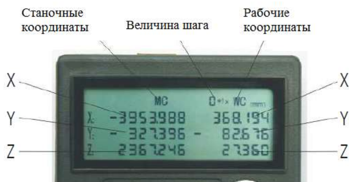
Рис. 4. Дисплей пульта LHB03 в режиме управления осями
