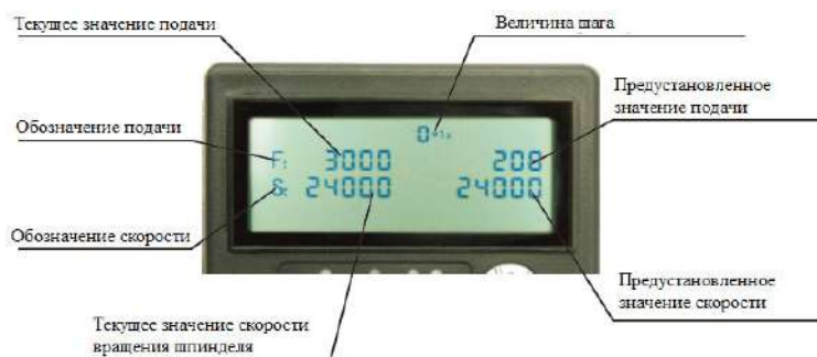
Рис. 5. Дисплей пульта LHB03 в режиме управления скоростью шпинделя или подачи
