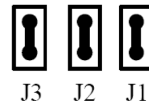
(d) J1, J2, J3 - перемычки установлены. Режим CW/CCW, шаг по переднему фронту импульса (фиксированный)
