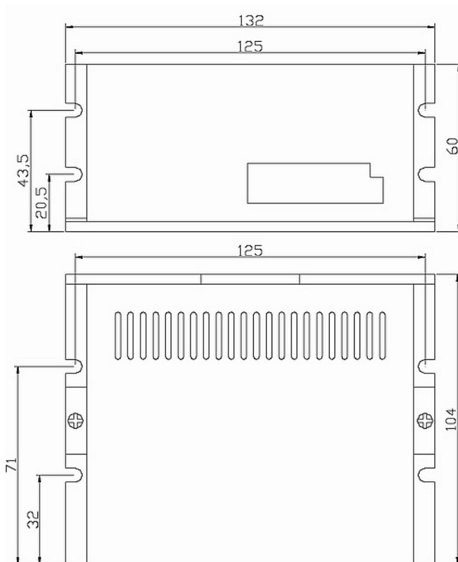
Рис. 2. Габаритные и установочные размеры источников питания
