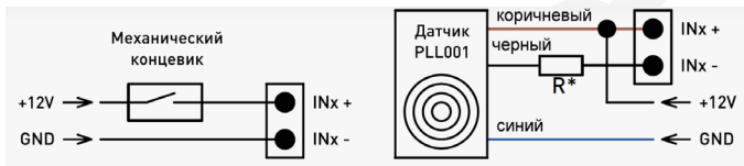
Рис. 3. Схема подключения датчиков
