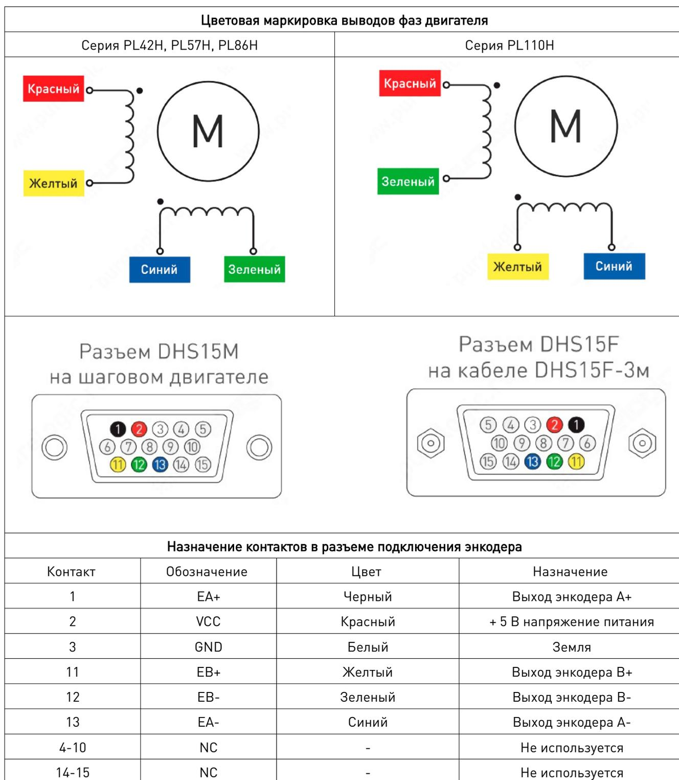
Рис. 3. Подключение шаговых двигателей с энкодером
