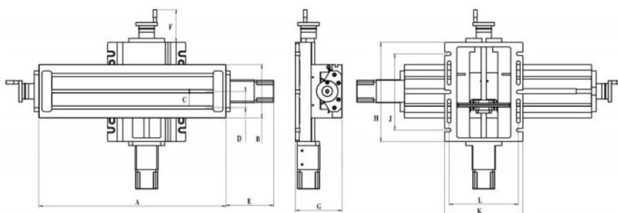
Рис. 1. Габаритные и установочные размеры автоматизированных координатных столов
