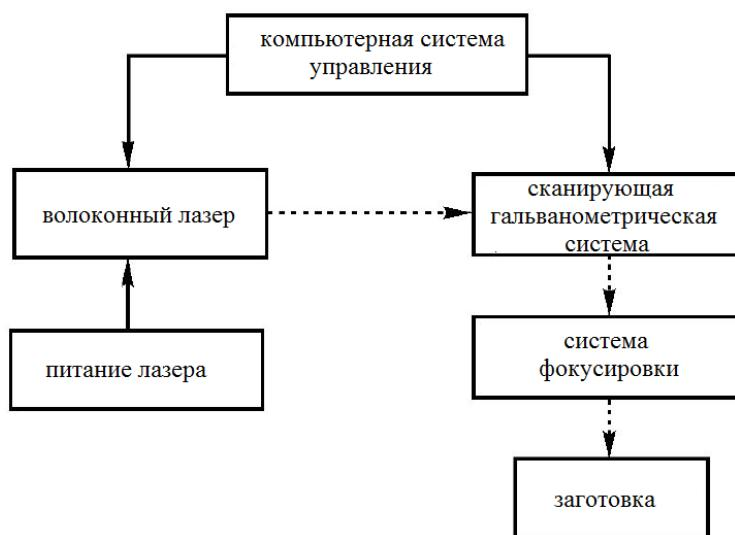
Рис. 2. Основные системы лазерного маркировочного станка
