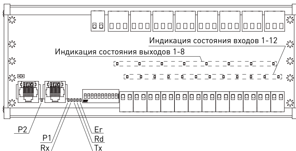
Рисунок 12 — Расположение светодиодной индикации PLP-8R12-CAN/RS485, PLP-8T12-CAN/RS485.
