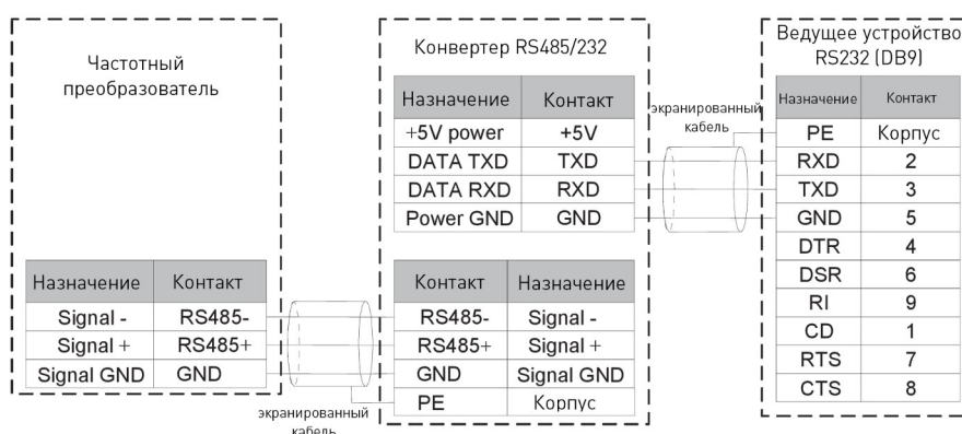
Рис. 10. Подключение частотного преобразователя и ведущего устройства при помощи интерфейса RS232
