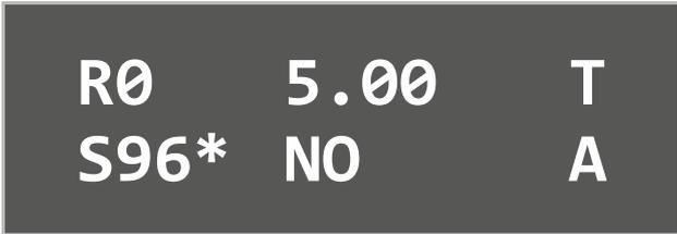
Рисунок 25 — Система ЧПУ заблокировала регулирование.
