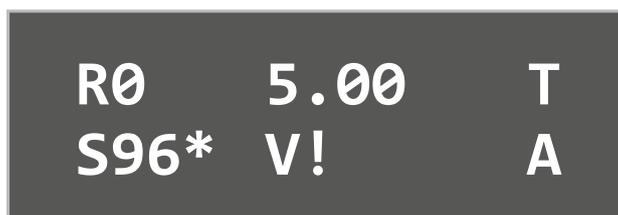
Рисунок 24 — Индикация при OVERVOLTAGE.
