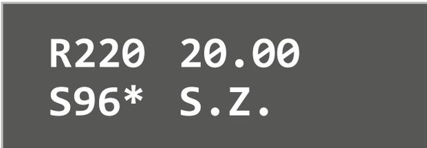
Рисунок 27 — Резак находится на безопасной высоте (Safe Z).
