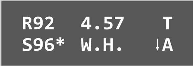
Рисунок 26 — Выполнение регулирования (стрелка вниз — резак движется вниз).
