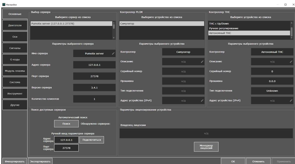
Рисунок 18 — Выбор режима работы с автономным контроллером THC3.
